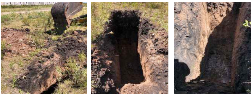
Cateo 3 – Se observa claramente el perfil del suelo
